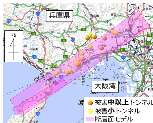
図-4 兵庫南部地震の被害トンネルと断層面の位置
