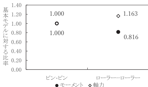
図-10 支点条件を変えた場合の曲げモーメントの変化
