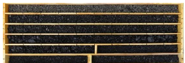
写真-2 トンネル坑内からの水平ボーリング
