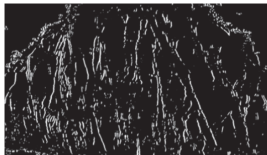
図-14 割れ目抽出画像
