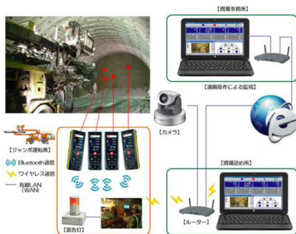
図-1 多点同時変位計測システムを用いた 切羽安全監視システムの概要 1)
