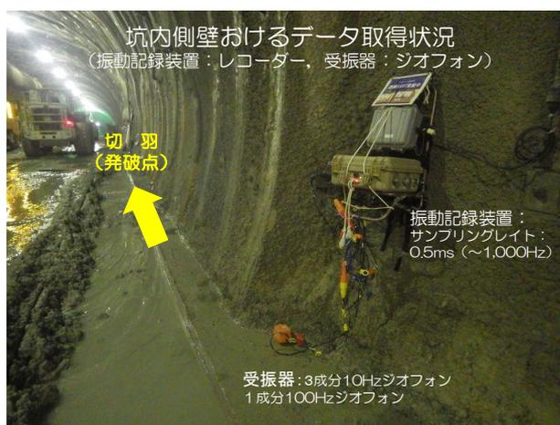
写真-1 坑内側壁における観測機器の設置状況
