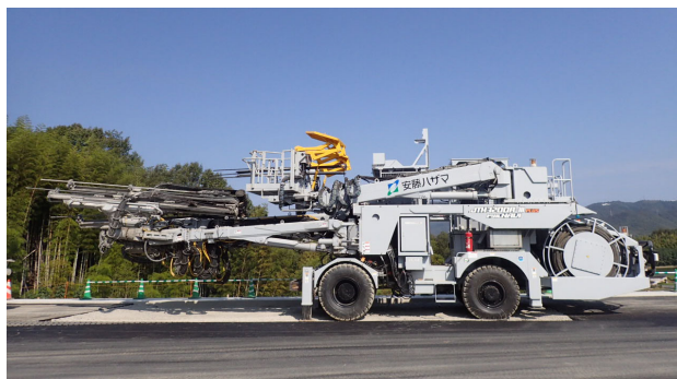
写真-5 遠隔改造した MG ジャンボ
