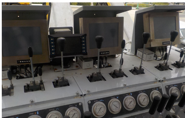
写真-6 電磁バルブ化した運転席
