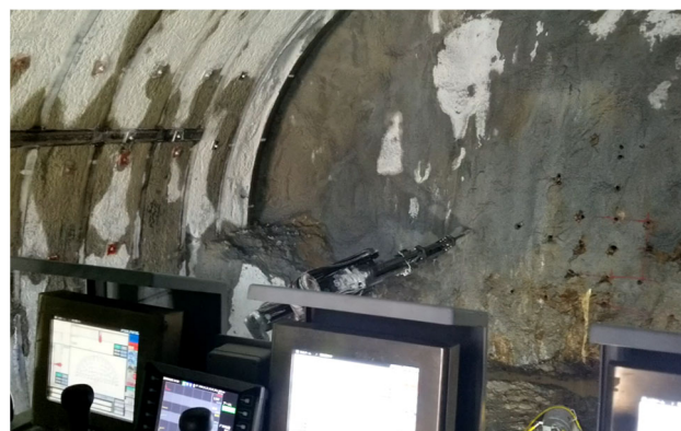
写真-2 運転席のマシンガイダンス画面
