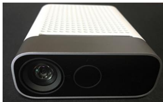
図-1 Azure Kinect (切羽監視カメラ)
