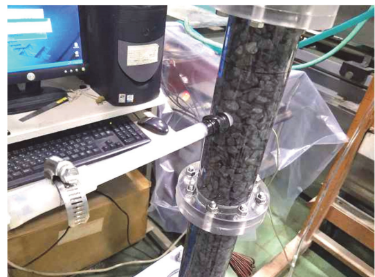
写真-2 ラインミキサーと模型地盤
