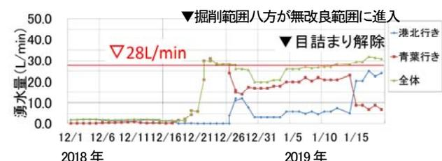
図-15 湧水量計測結果
