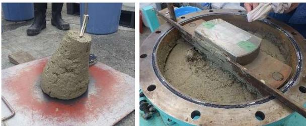
写真-1 攪拌前の作成土（砂質土）
