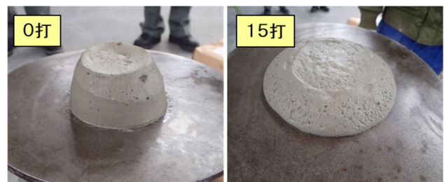
写真-3 フロー試験状況
