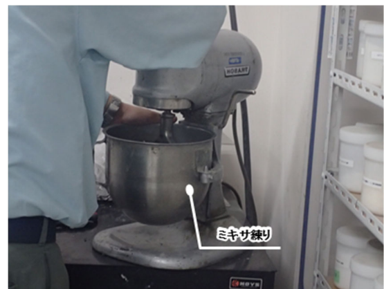
写真-2 ミキサによる練り混ぜ試験状況
