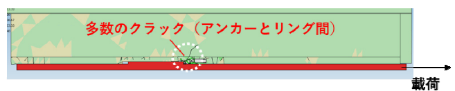
(b) アンカー部モルタル内移動中（水平変位10mm）
