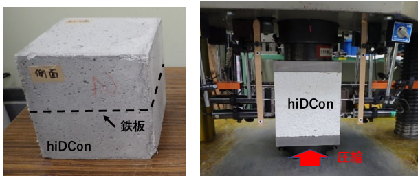
図-18 供試体写真（左）と載荷状況（右）
