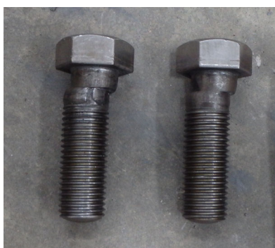
写真-8 2面せん断試験後のボルトの状況
