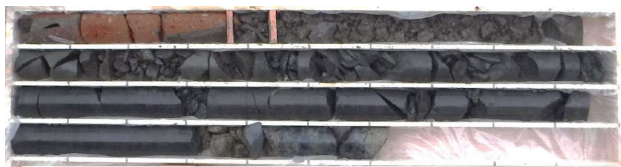
図-2 測定箇所①（変状部）のコア（コア長 L=3.6m）
