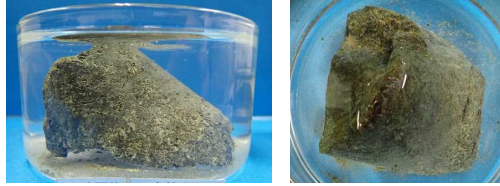
図-7 遷移部のスレーキング試験の結果
