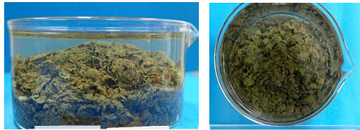
図-6 変状部のスレーキング試験の結果
