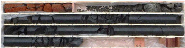
図-3 測定箇所②（遷移部）のコア（コア長 L=3.4m）
