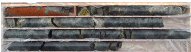
図-4 測定箇所③（健全部）のコア（コア長 L=3.4m）
