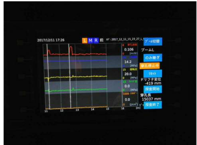
写真-6 ドリルジャンボによる前方探査記録
