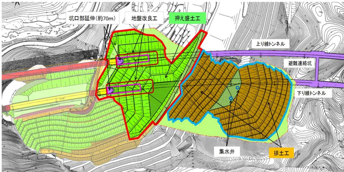
図-6 地すべり対策工平面図
