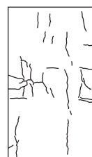
図-7 ひび割れ展開図(S001)
