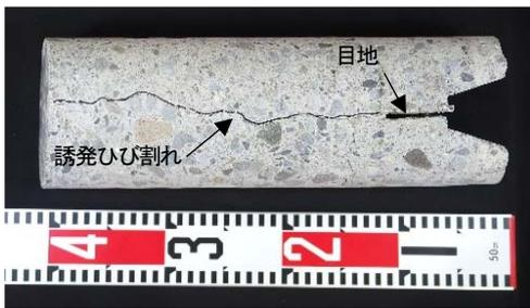
写真-8 側壁目地部コアの誘発ひび割れ (Case3)
