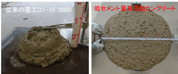
写真4 従来の覆工(左)と高流動コン(右)の外観
