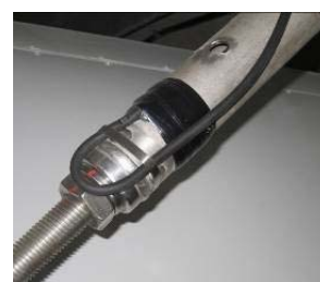
写真-1 軸力計測状況
