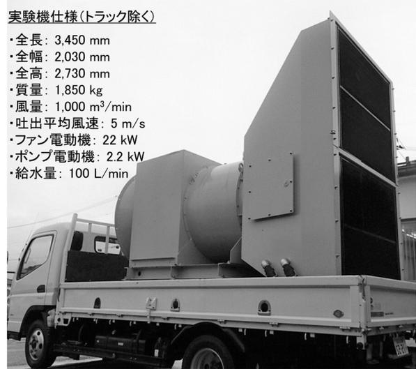
図-1 冷風発生装置実験機の外観と仕様
