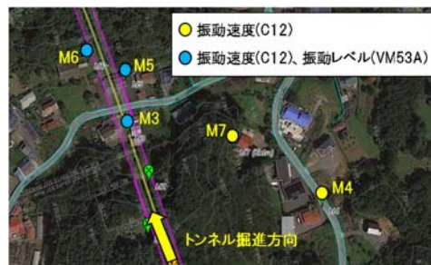
図-3 計測点とトンネル線形の平面図
