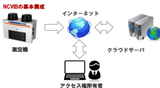
図-6 遠隔型の発破振動計測システム (NCVIB)
