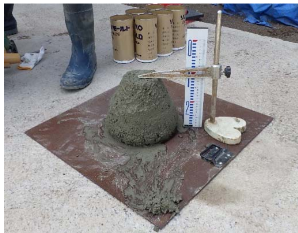
写真-3 ベースコンクリート性状確認状況(スランプ試験)
