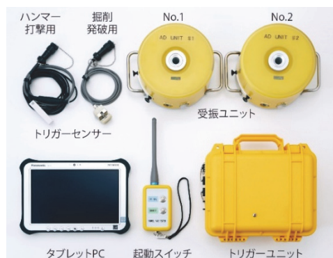
写真-1 TFT探査システム構成
