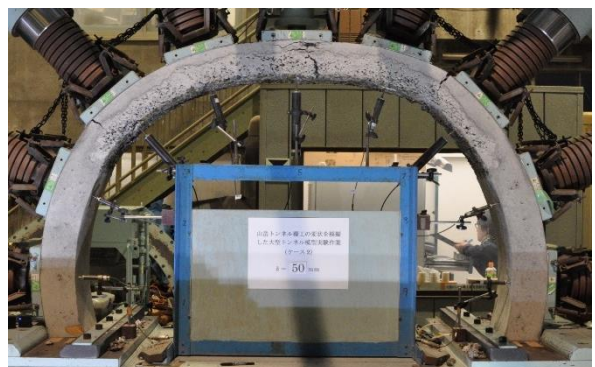
図-13 Case3（著しい材料分離）破壊状況（ \delta=50\text{mm} ）
