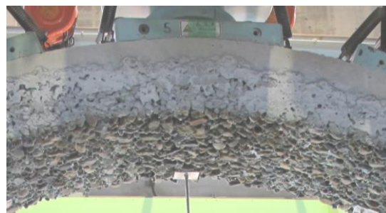
図-6 模擬ジャンカ作製状況 (Case3)
