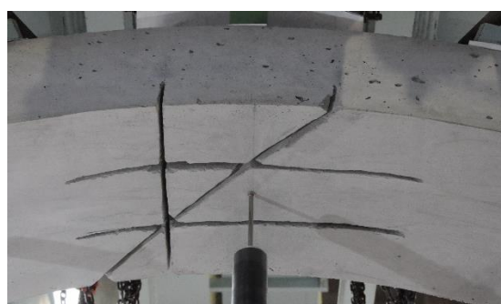
図-7 作製した模擬ひび割れ (Case5)
