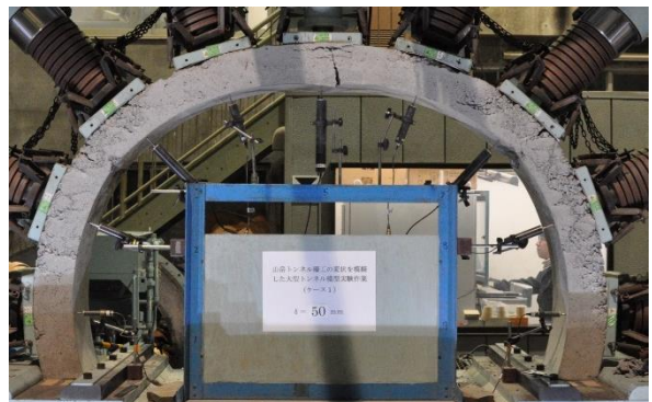
図-12 Case2（軽度の材料分離）破壊状況（ \delta=50\text{mm} ）
