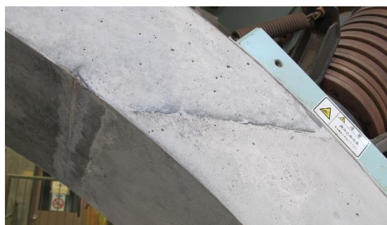
図-8 作製したコールドジョイント (Case6)
