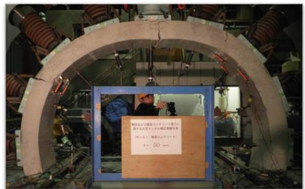
図-11 Case1（構造欠陥なし）破壊状況（ \delta=50\text{mm} ）
