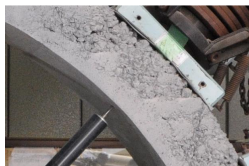
図-4 材料分離の状況（Case2）
