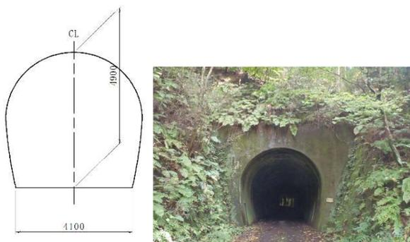
図-3 トンネル断面図及び終点側坑口部写真
