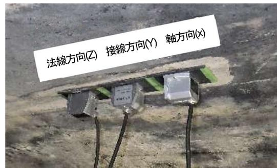
写真-1 加速度計取り付け状況
