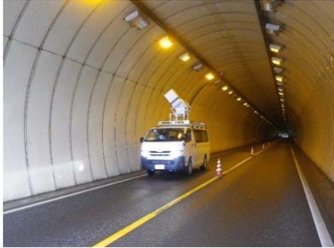
写真-5 非接触型レーダ探査状況
