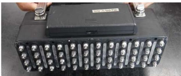
図-1 試験装置底面に設置されたプロープ
