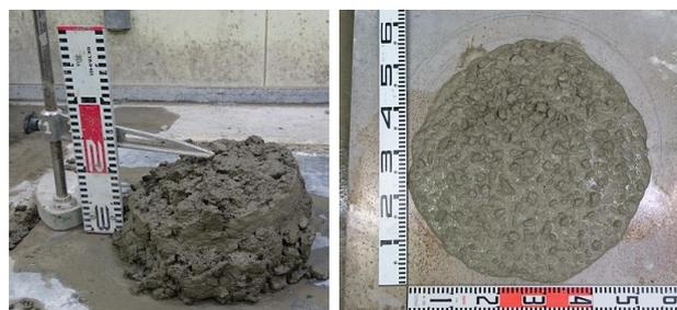
写真-2 従来の覆工(左)と高流動コン(右)の外観
