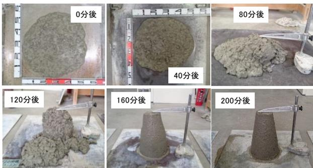
写真-4 静置スランブ試験状況 (写真中の数値は静置時間)
