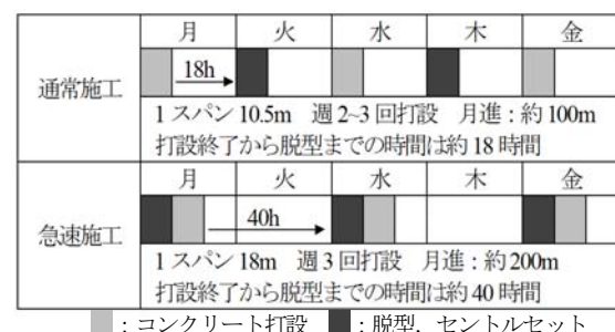
図-1 施工サイクルのイメージ
