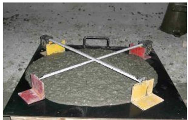
図-2 スランプフロー試験の状況
