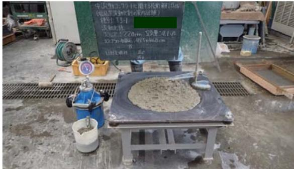
図-4 室内試験の状況（流動化後）
