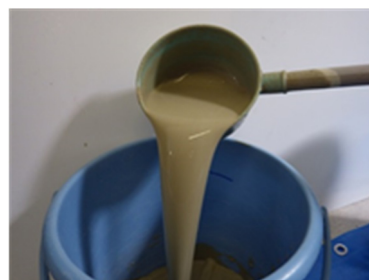
写真-4 沈下抑止特殊充填材（A液）の流動性
