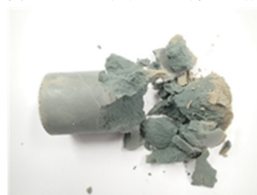
写真-6 固化後の沈下抑止特殊充填材
