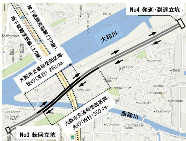
図-3 御堂筋線交差部 平面図
