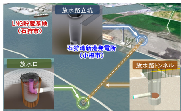
図-1 石狩湾新港放水設備工事概要図
