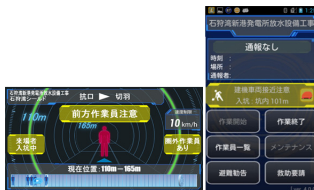
図-6 バッテリーロコ接近警報時の作動画面 (左：ロコ搭載タブレット 右：スマートフォン)
