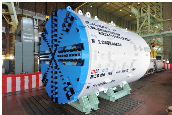
写真-1 シールドマシン全景
