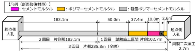
図-5 補修工事範囲図 (1984年)
