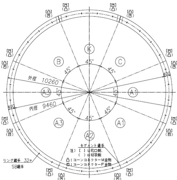
図-4 鉄筋コンクリート製セグメント断面図
