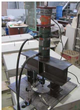
写真-1 アンカー引抜き試験の様子
