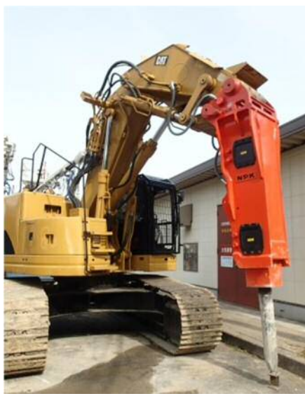
写真-2 4t級の大型ブレーカ
