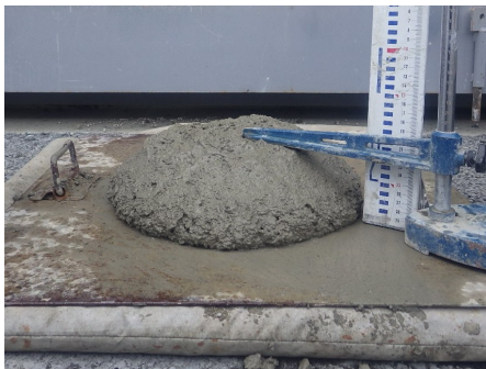
写真-1 スランプ試験の例
