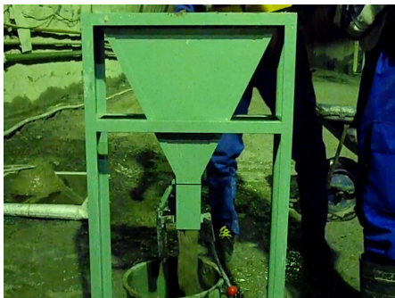
写真-2 V 75 漏斗試験の状況
