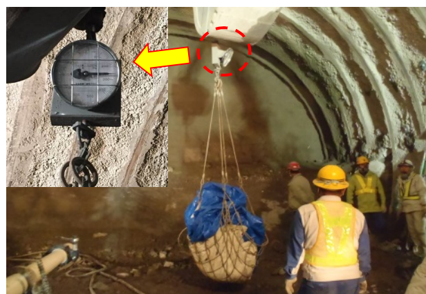
写真-5 はね返り率試験状況 (2)
