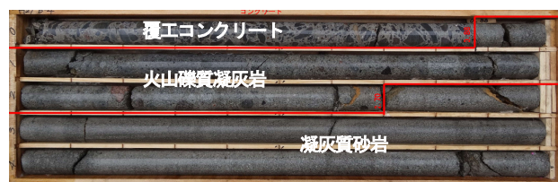
写真-5 調査ボーリングコア写真 (水平, 下り, No.58)
