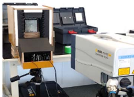
写真-2 レーザドップラ振動計による室内試験
