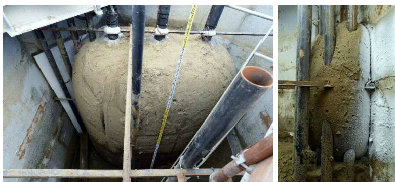
図-12 掘り起こした凍土(左：鉛直 右：貼付)
