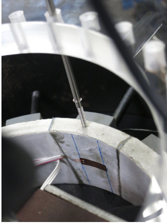
(b) Kセグメントへの変位計の設置
