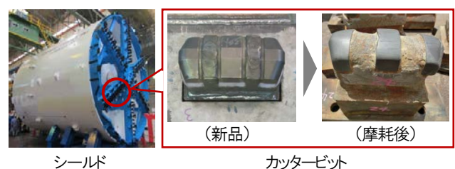
図-1 シールドカッタービットの摩耗
