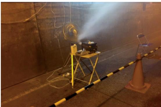
図-3 スモークマシンによる発煙状況
