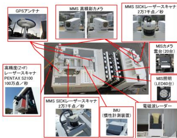
図-1 走行型計測システムの概要（MIMM-R） 2)3)4)
