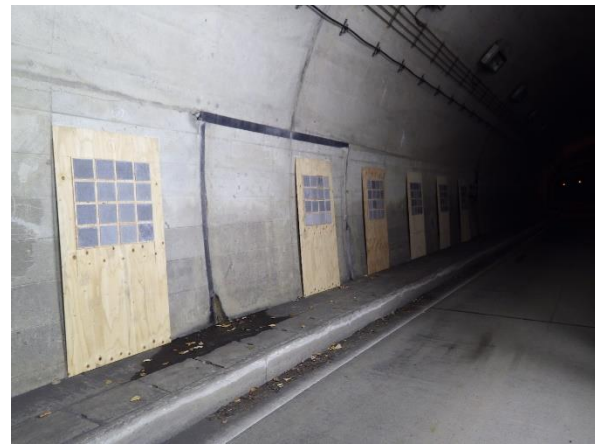
写真-1 ひびわれ模擬供試体の外観
