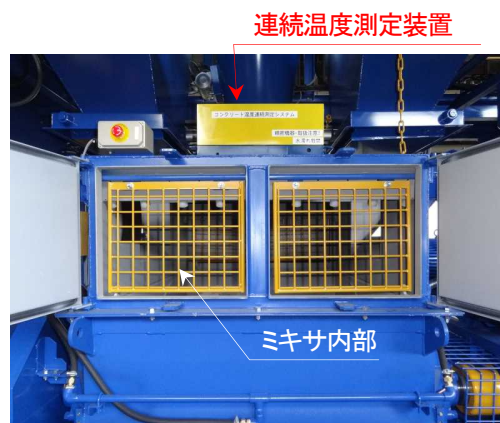
写真-1 ミキサ内の温度測定システム
