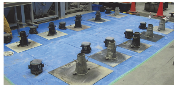
写真-2 充填後のスランプの経時変化の測定
